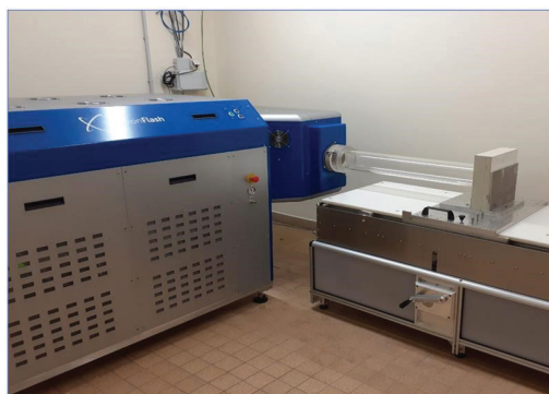
Figura 2 In figura, un esempio di apparecchiatura per radioterapia preclinica Flash. Il fascio di elettroni viaggia dentro il collimatore plastico in direzione del campione, costituito da un campione biologico, una cavia o un fantoccio per misure dosimetriche.
